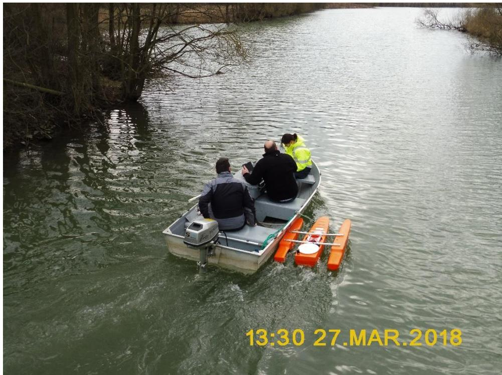
Abb. 5-5: Boot mit seitlich montiertem ADCP-Messgerät
